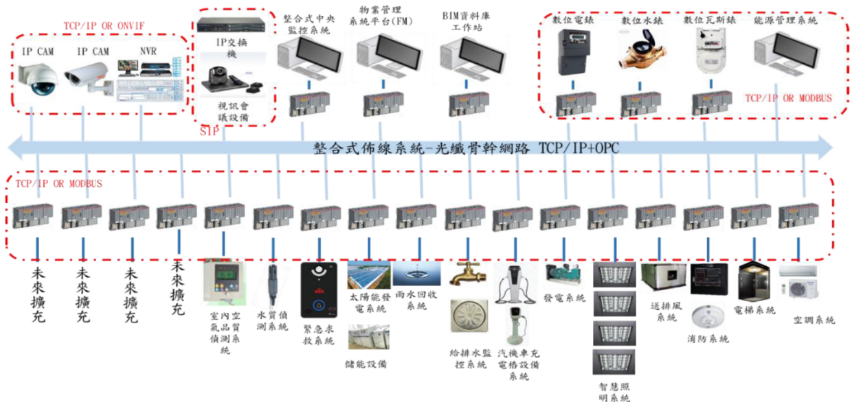
圖 4 社會住宅中央監控系統整合管理平臺(臺北廣慈博愛園區 ABCDE 區)
